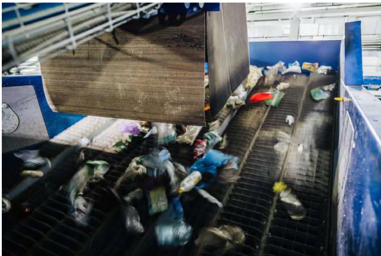
Рис. 22. Процесс баллистической сепарации
