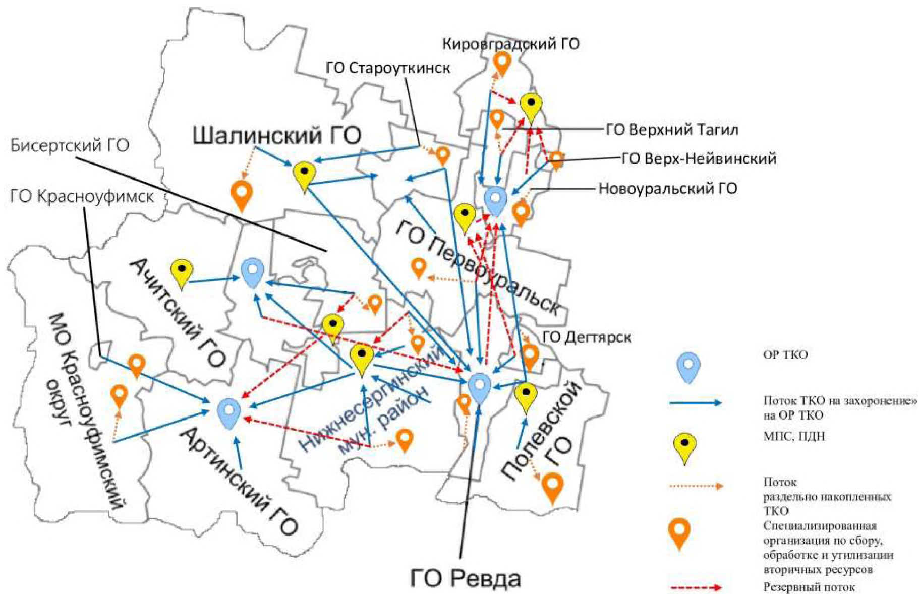
Рис. 7. Схема потоков ТКО АПО-2 (II этап)
